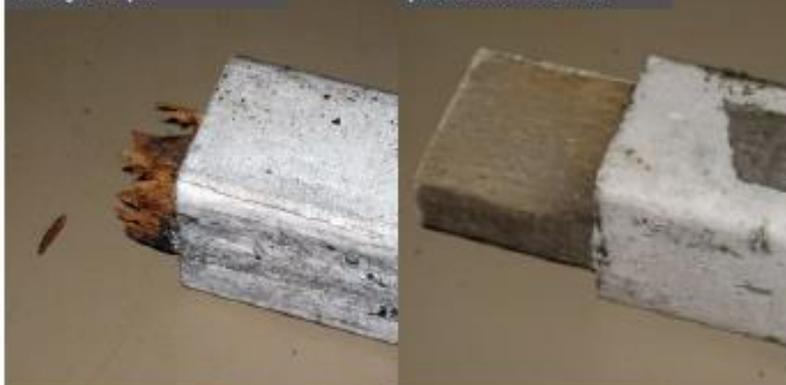
La madera no acetilada muestra un alto nivel de putrefacción y deterioro
